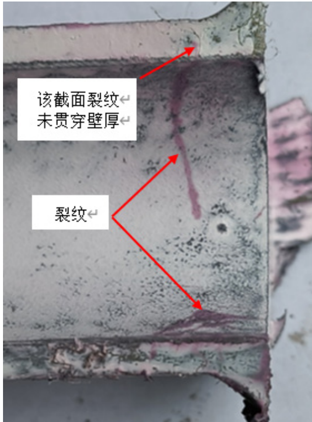
> 图2管道泄漏处找色探伤
