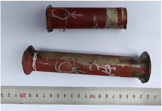
> 图 1 泄漏接管外壁
